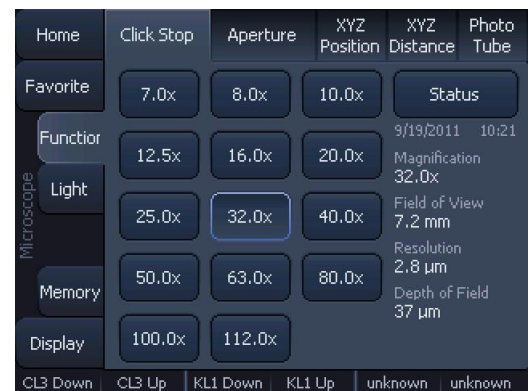
Figura 29: Panel de control Sycop3 mostrando las ampliaciones preestablecidas
