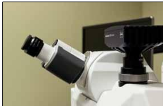
Figure 25: Posición de máxima inclinación de los binoculares en el microscopio de comparación Discovery-Z
