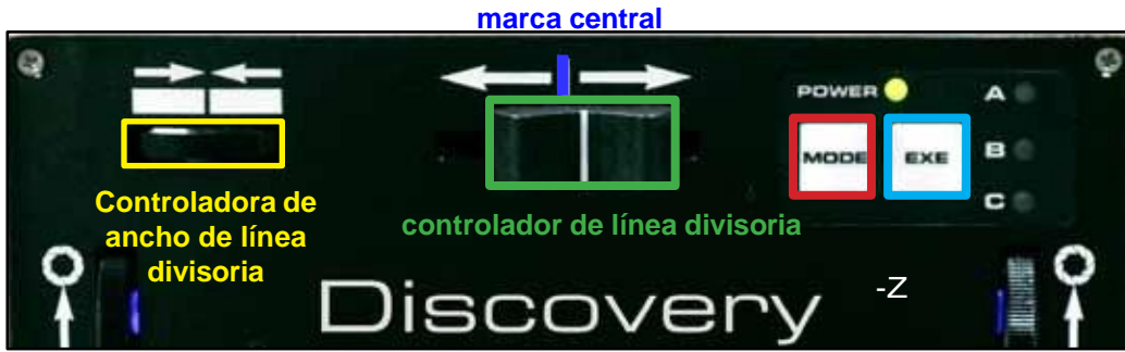
Figura 27: Botón MODE: Al seleccionar el botón MODE se alternará entre 3 modos (A, B, C).
