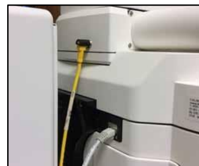
Figura 21. Conecte el extremo doble como se muestra arriba: conector blanco a la parte posterior del puente. Conector amarillo a la parte posterior del módulo puntero.
