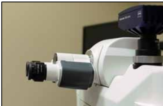
Figure 24: Posición de inclinación más baja de los binoculares en el microscopio de comparación Discovery-Z
