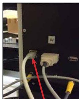
Figura 20 Conecte un extremo del cable en Y a la parte posterior de la columna.
